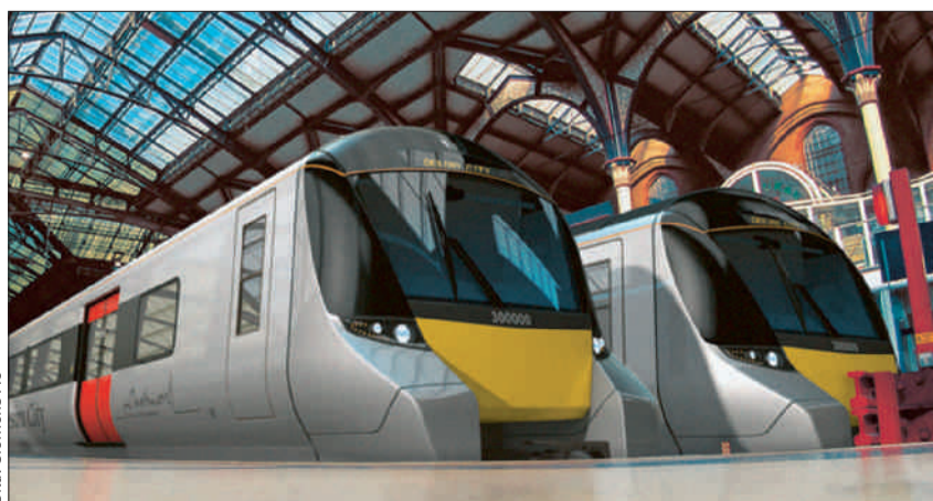
Der Desiro City von Siemens Mobility ist ein neues Plattform-Konzept für den S-Bahn-, Regional- und Interregionalverkehr. Die Leichtbauweise des Zuges sowie eine intelligente Fahrzeugsteuerung reduzieren den gesamten Energieverbrauch um bis zu 50%.
